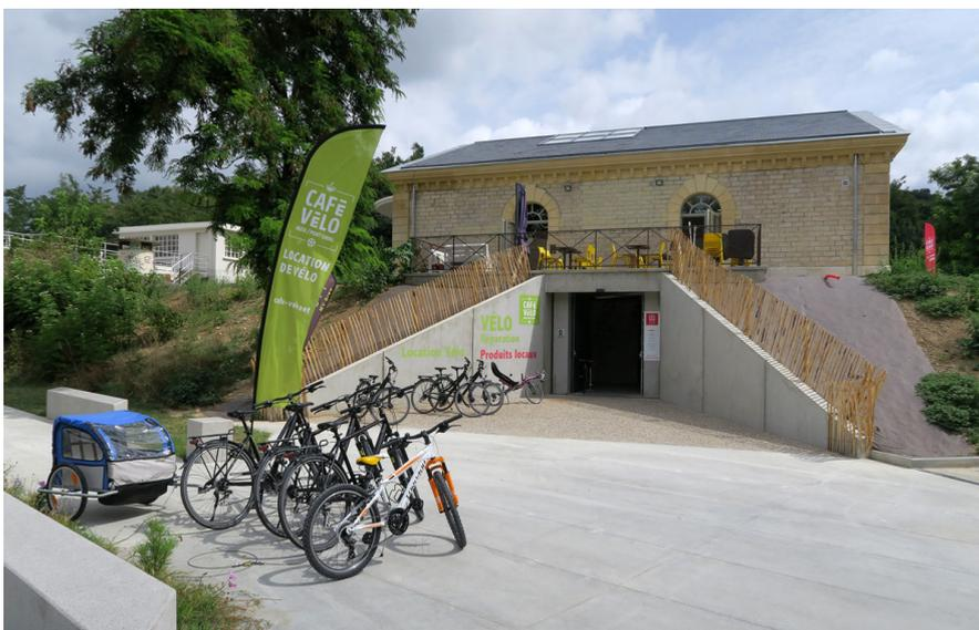
La façade ouest a été reconstruite en pierre, elle donne sur une terrasse qui reprend les dimensions au sol du poste de transformation démoli. Les murs de soutènement de talus créés pour la galerie couverte du niveau inférieur sont en béton. Par cette ouverture, le visiteur accède directement au service de location-réparation de vélos. Une piste cyclable passant sous le Pont Canal mène au skate park.
